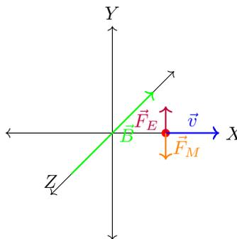
Por lo tanto, los campos eléctrico y magnético deben ser perpendiculares entre sí y orientados de manera que  $\vec{E}$  sea igual y opuesto a  $\vec{v} \times \vec{B}$ .
